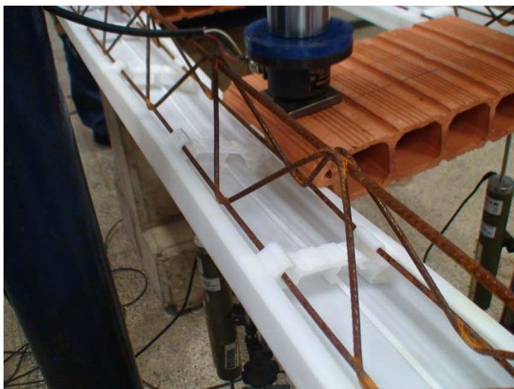
Falha pela ruptura do gancho do clip de fixação no exemplar T8-2
