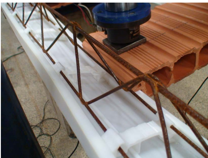
Falha pela soltura da treliça do clip de fixação no exemplar T8-1
