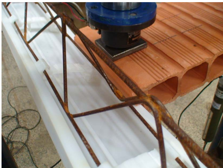
Falha pela soltura da treliça do clip de fixação no exemplar T8-3
